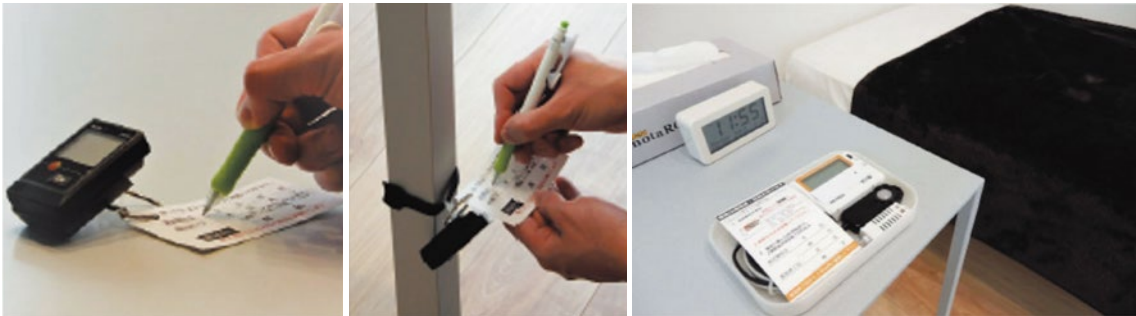
住宅の上下温湿度・照度の測定
